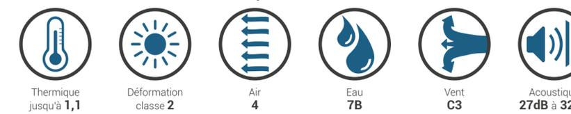
**Thermique** : calcul réalisé selon la norme EN ISO 10077-1 et -2 sur porte pleine avec dimension d'ouvrant de 2350 x 1070 mm et rejet d'eau. **AEV** : essais réalisés selon la norme NF P 20-501. N° 404/2019/243-1 du 06/12/2019. **Ensoleillement** : selon norme NF EN 12219. **Acoustique** : Classification selon la norme ISO 717-1 sur porte pleine de dimension HT 2180 x 960 mm.
